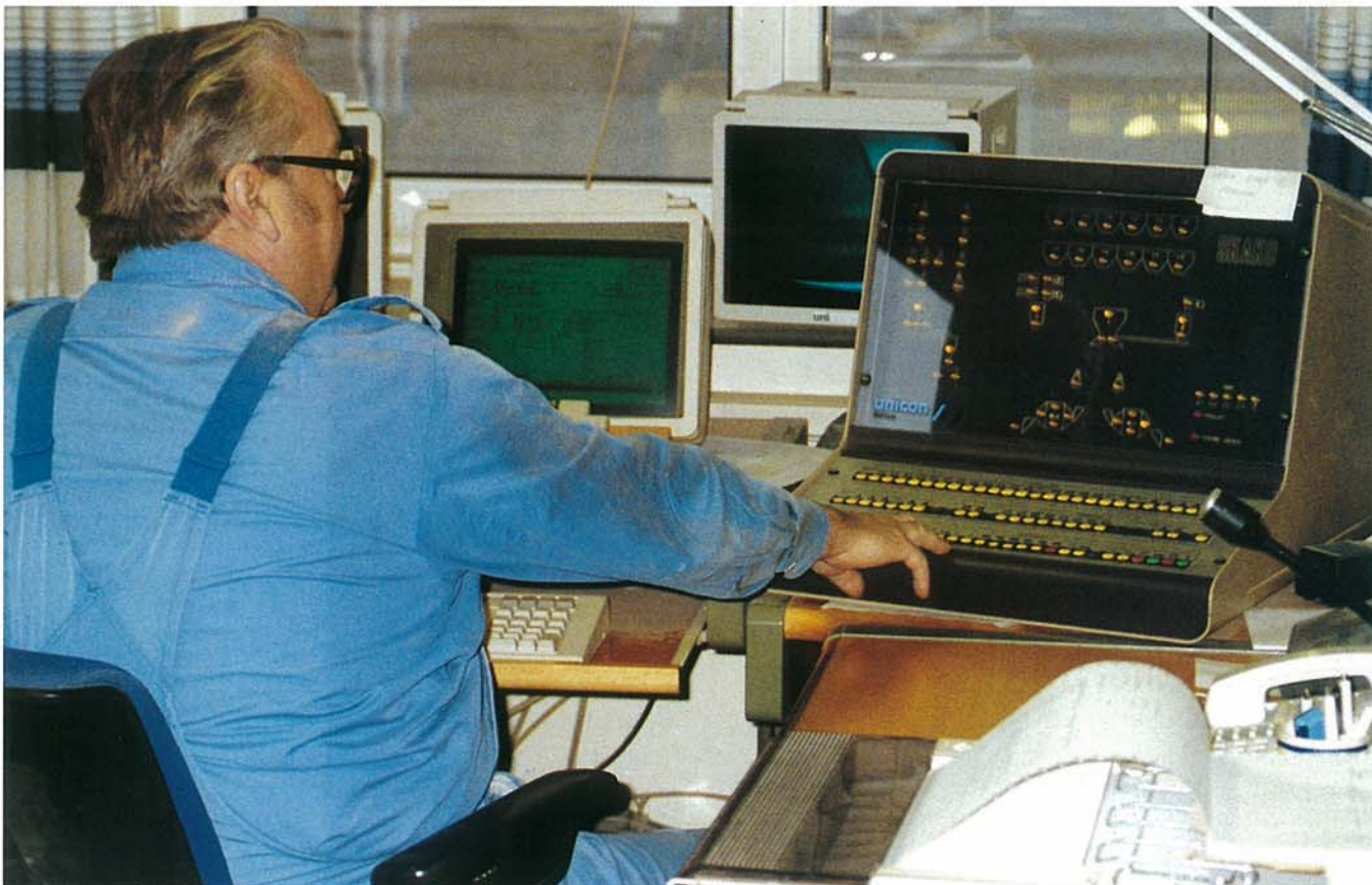
Kontrolrum på fabriksbetonværk, hvor betonens delmaterialer sammensættes og kvaliteten overvåges.
